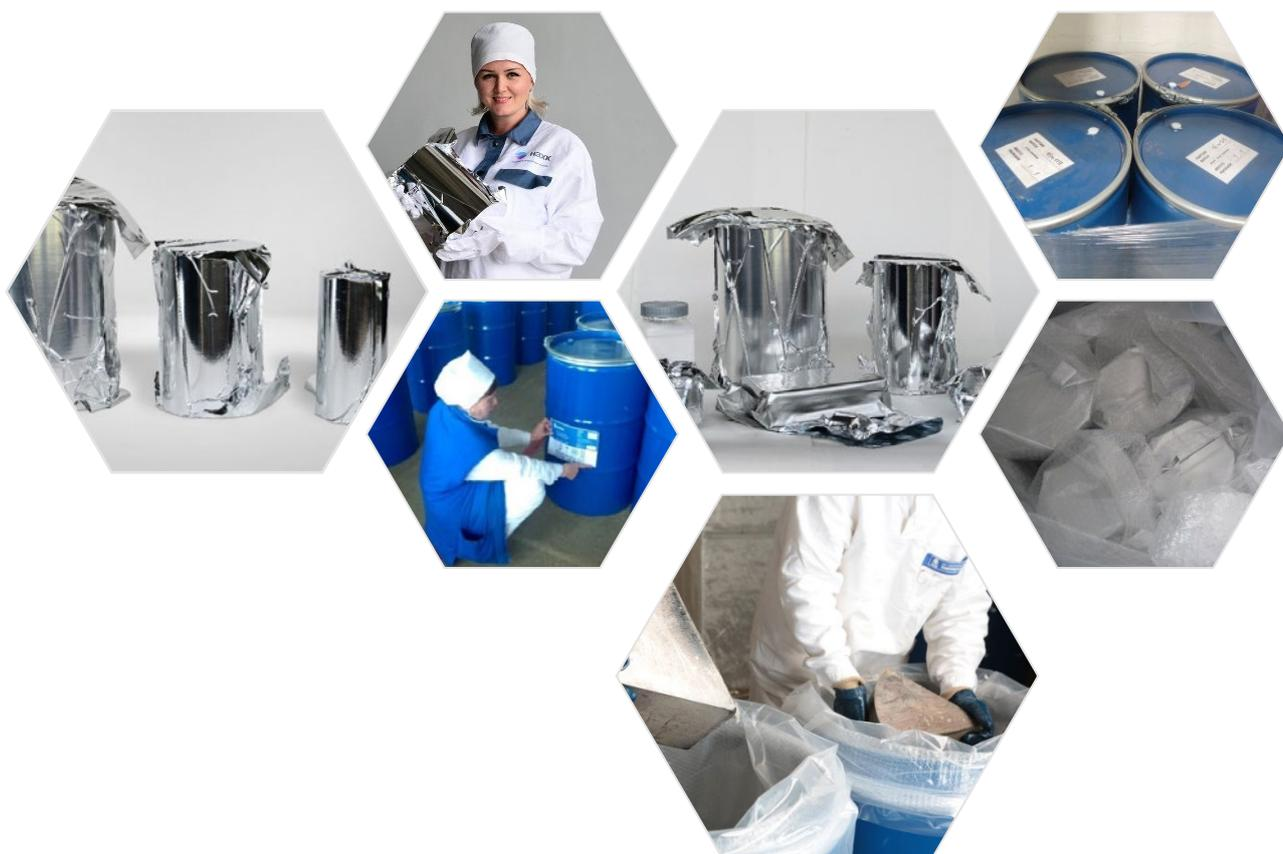
Слитки упаковывают в ламинированный алюминием полиэтиленовый пакет, который герметизируют в среде инертного газа (аргона) и помещают в пакет из пузырчатого полиэтилена.
